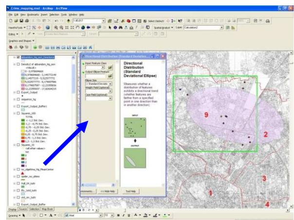
Screen-shot del tool che consente l’elaborazione di una “ellisse delle deviazioni standard”. Il tool si attiva con uno specifico comando (directional distribution) da lanciare all’interno dell’estensione Spatial Statistics Tools.
