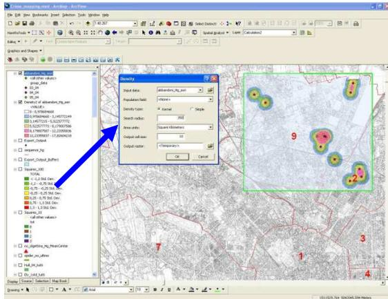
Screen-shot del tool “Density Analysis” dell’estensione Spatial Analysis che consente di individuare gli hot-spots tramite l’analisi di densità di tipo Kernel. Il tool si attiva con uno specifico comando (density) da lanciare all’interno dell’estensione” Spatial Analyst”.
