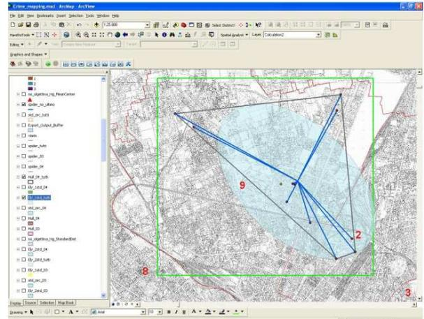
Screen-shot degli output del tool SPACE: in particolare si mostrano l’ellisse della deviazione standard, il convex-hull poligon, lo spider diagram e la definizione della “analysis area”; le elaborazioni sono state fatte su una serie di punti riconducibili a un fatto di reato di natura seriale (dati reali).
